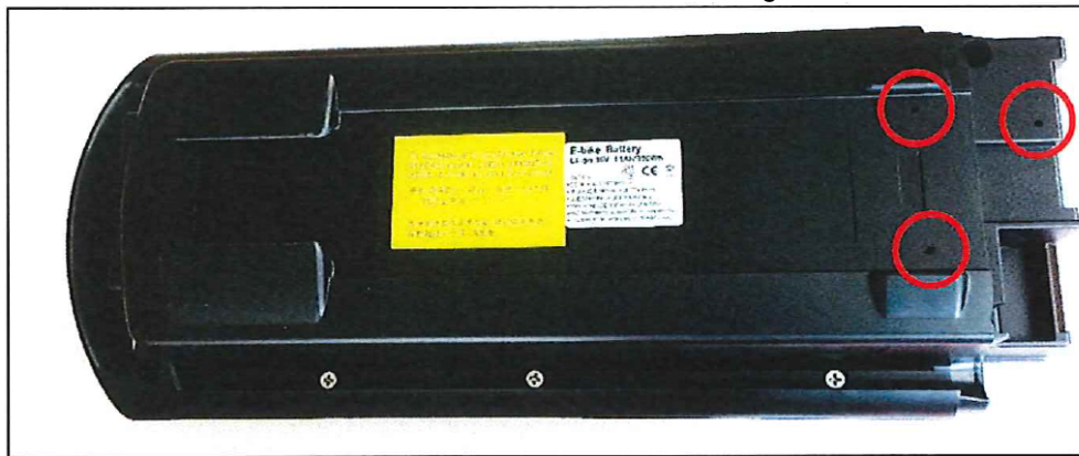
Bild 3: Erneuerte Batterie mit Entwässerungslöchern
